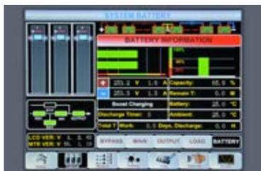
Il contatore dei tempi di scarica e del tempo totale di lavoro delle batterie consente una analisi costante e precisa dello stato delle batterie.
