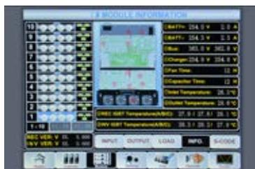
L'accesso ai dati di gestione dei moduli permette il controllo della temperatura, della velocità delle ventole e l'uso dello Smart Parallel Management.
